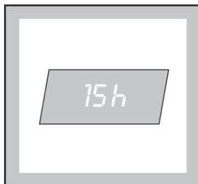
Время задержки появляется на 3 секунд, после чего высвечивается продолжительность выбранной программы. После нажатия кнопки СТАРТ/ПАУЗА начинается отсчет, и значение задержки уменьшается на одну единицу в час. Задержку включения выбранной программы можно отложить до 23 часов с интервалами в один час.
